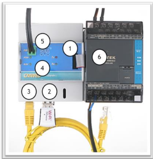
Připojení k PLC FATEK plochým propojovacím kabelem.
