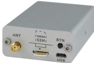
Vzdálenou správou se rozumí možnost odesílání SMS při změně registrů připojených zařízení a také možnost vzdáleného nastavení hodnot v registrech připojených zařízení. GSM-MODBUS má kromě sériové linky také jeden digitální vstup a výstup pro obecné použití. Vstup se použije například pro hlídání, zda funguje připojené zařízení a výstup umožní jeho vzdálený reset. SMS dotazem lze kdykoliv zjistit stav GSM-MODBUS i stav předdefinovaných registrů v připojených zařízeních.
